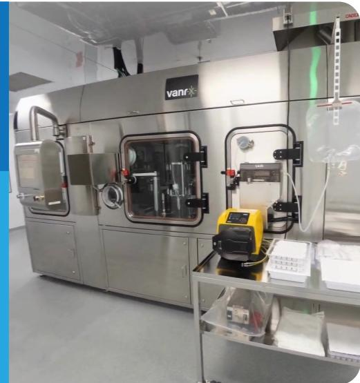
Opérations de remplissage et finition utilisant une technologie d'isolateur robotisé et des surfaces de contact à usage unique. Pertes minimales sur la ligne, adaptées aux remplissages de petits volumes.
